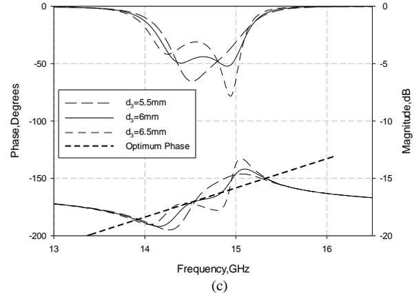
Fig. 6. Complex Reflection Coefficients of the three-layer PRS changing (a) the first layer patch dimensions  $d_1$  ( $h_1=9.5\text{mm}$ ,  $h_2=10\text{mm}$ ,  $d_2=10\text{mm}$ ,  $d_3=6\text{mm}$ ), (b) the second layer patch dimensions  $d_2$  ( $h_1=9.5\text{mm}$ ,  $h_2=10\text{mm}$ ,  $d_1=9.16\text{mm}$ ,  $d_3=6\text{mm}$ ) and (c) the third layer patch dimensions  $d_3$  ( $h_1=9.5\text{mm}$ ,  $h_2=10\text{mm}$ ,  $d_1=9.16\text{mm}$ ,  $d_2=10\text{mm}$ ).
