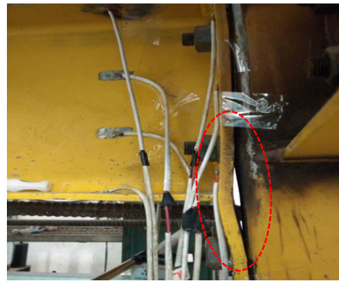
(d) Bending of extended end plate
