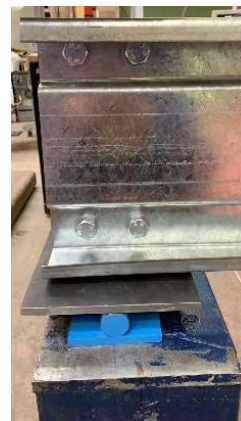
Fig. 4. web crippling test set up
