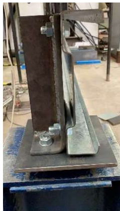
Fig. 4. web crippling test set up
