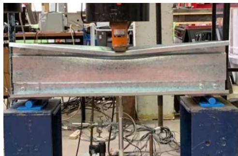
Fig. 4. web crippling test set up
