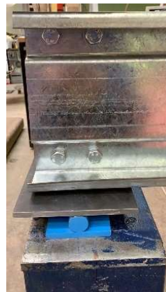
Fig. 4. web crippling test set up
